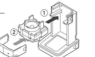
4 噴射ユニットにタンクを差し込み①、タンクカバーを被せる②
